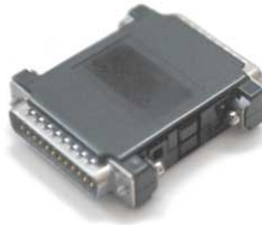
Dongles: chaves eletrônicas que tentam impedir o uso não autorizado de um software
