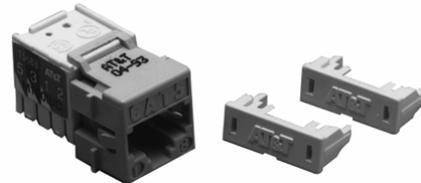
Os conectores modulares de 8 posições do tipo RJ45 fêmea devem ter um banho de ouro de pelo menos 40 micro polegadas de ouro nos contatos, sobre uma camada de pelo menos 80 micro polegadas de nickel. As tomadas devem ser manufaturadas de material termoplástico de alto impacto e retardante à chama. Os condutores da tomada (não do cabo) devem ter pelo menos um trançamento interno de maneira a melhorar a performance da mesma.
