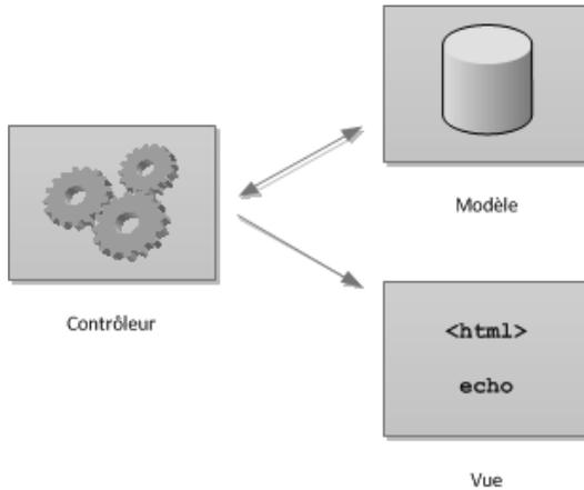
FIG. 28.2 – Échange d'informations entre les éléments
