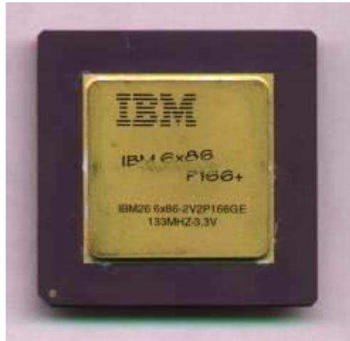
No caso do processador da foto o "P166+" é o índice Pr do processador e o "133 mhz" da ultima linha é seu clock real de operação.
