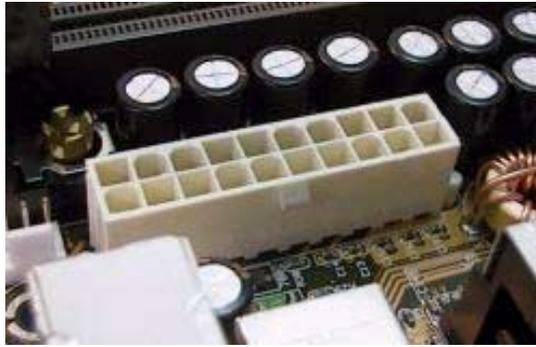
Figura 3 - Conector para fonte de alimentação em uma placa de CPU ATX
