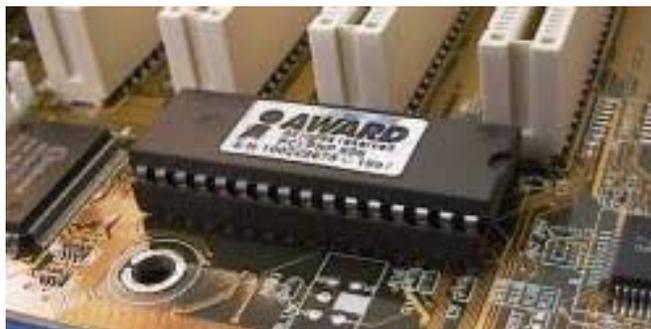
Figura 12 - BIOS da placa de CPU
