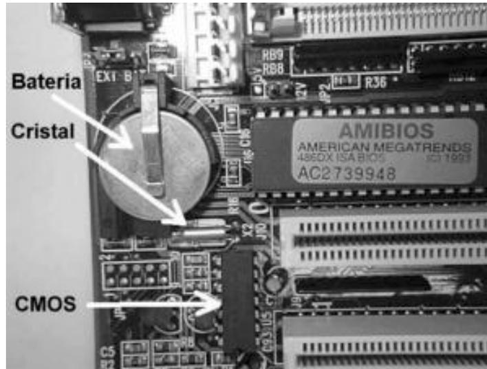
Figura 11 - Exemplo de chip CMOS e sua bateria.
