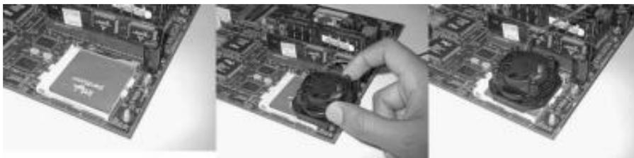
Figura 6 - Acoplando um micro ventilador no Pentium.
