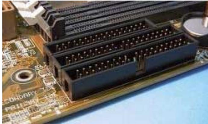
Figura 15 - Conectores das interfaces IDE e interface para drivers de disquete
