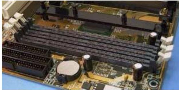
Figura 5 - Soquetes para memórias DIMM
