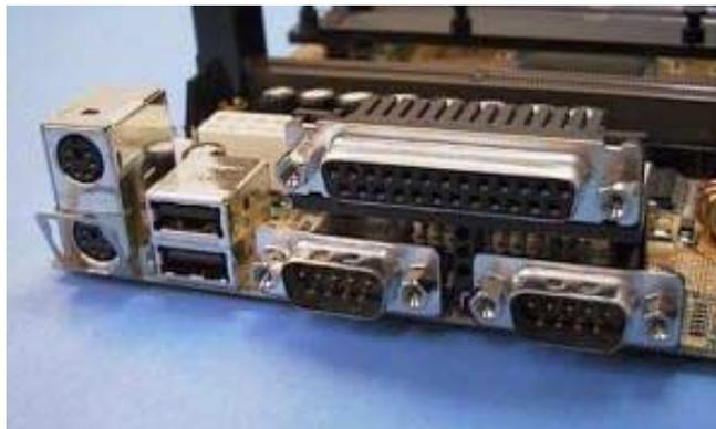
Figura 16 - Conexões na parte traseira de uma placa ATX
