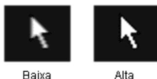
Figura 14 - Imagem em um monitor com largura de banda baixa e outra em um monitor com uma largura de banda alta, ambos operando com a mesma resolução e a mesma frequência horizontal.
