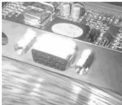
Figura 8 - Conector DB-15 da placa SVGA, para a conexão do monitor.
