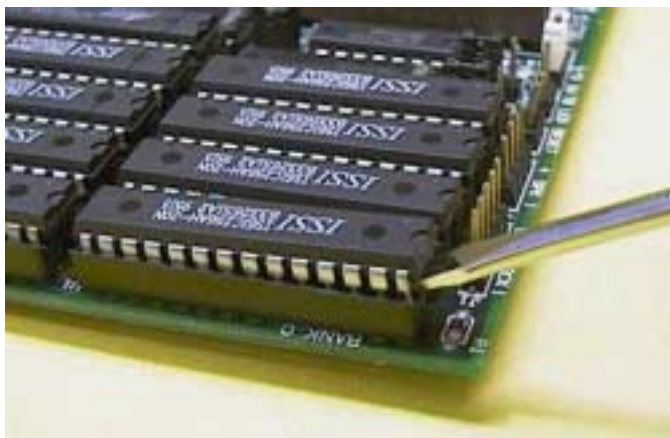
Figura 1 – Extraindo um chip com o auxílio de uma chave de fenda.
