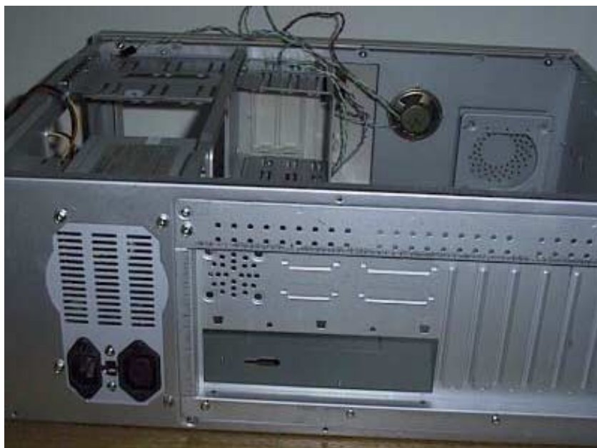
Figura 2 - Parte traseira de um gabinete ATX
