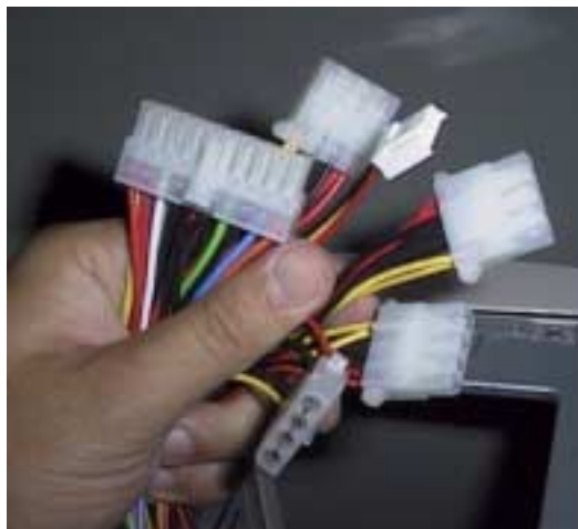
Figura 5 - Conectores de uma fonte de alimentação ATX
