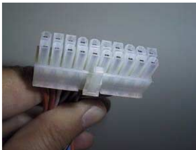
Figura 4 - Conector de alimentação para a placa de CPU ATX
