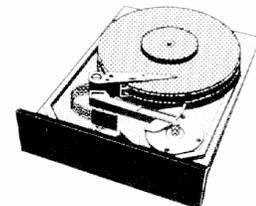
Existem vários tipos de HD, assim como vimos com os Microprocessadores, porém não medimos o HD pela potência e sim pela capacidade, ou seja a quantidade de informações que cabem dentro dele.
