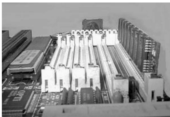
Figura 2 - Bancos de memória de uma placa de CPU 486 que aceita, tanto módulos de 30 como de 72 pinos.
