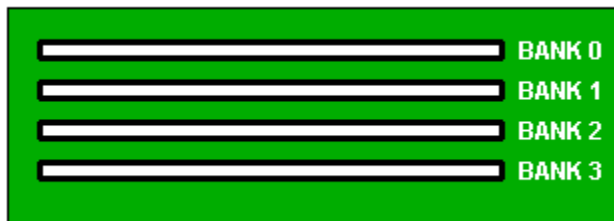
Figura 23 - 4 bancos de memória, cada um deles formados por um módulo SIMM de 72 pinos.
