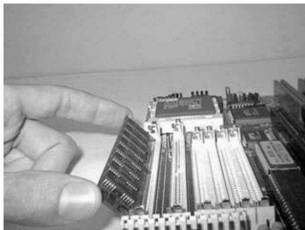
Figura 37 - Posicionando um módulo SIMM para encaixe no seu módulo.
