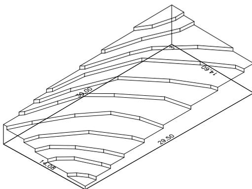
A vantagem da modelagem de terreno com sólidos é que fica fácil modelar e calcular o volume da movimentação de terra para a implantação do(s) edifício(s). No exemplo a seguir necessita-se de um patamar plano de 10 x 8.0 m para a implantação de uma edificação no nível 3.5 m. Desenhou-se um retângulo com as dimensões do patamar e criou-se um sólido extrudando o retângulo com 4m de
