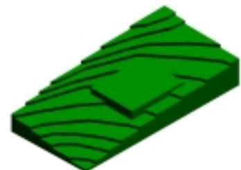
Da mesma forma, pode-se calcular a quantidade de terra a escavar modelando-se um sólido com o volume de terra a ser retirado e subtraindo este sólido do Terreno. A diferença no volume do Terreno antes e depois da subtração é a quantidade de terra a remover.
