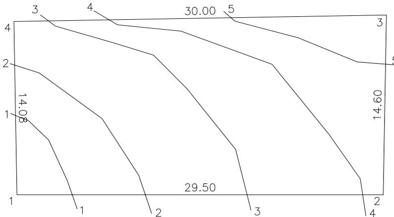
Acione, no menu suspenso, a opção **Modela\_3D -> Terreno**. Aparece o quadro de diálogo **Patamares 3D de Terreno** que solicita a diferença de nível entre as linhas e a camada que deve conter o terreno modelado em 3D.
