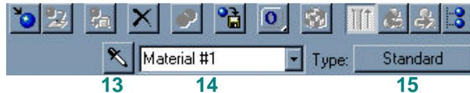
13. **Eye-dropper (conta-gotas)** – *permite coletar um material existente em uma cena e transferi-lo para (edição no) Material Editor.*
